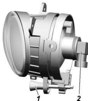
Рис. 9.36. Противотуманная фара: 1 -регулирующий винт; 2 -колодка жгута проводов
