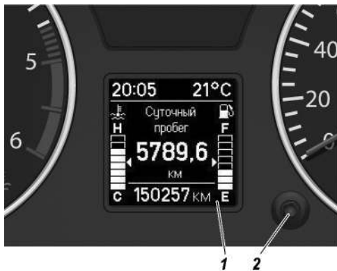
Рис. 3.6. Управление маршрутным компьютером на комбинации приборов: 1 -жидкокристаллический дисплей; 2 -переключатель маршрутного компьютера
