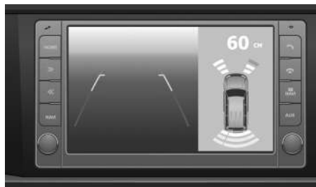
Рис. 3.21. Изображение с камеры заднего вида и информация системы помощи при парковке на экране мультимедийной системы
