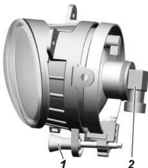
Рис. 9.40. Противотуманная фара: 1 -регулирующий винт; 2 -колодка жгута проводов
