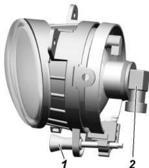
Рис. 9.40. Противотуманная фара: 1 -регулирующий винт; 2 -колодка жгута проводов
