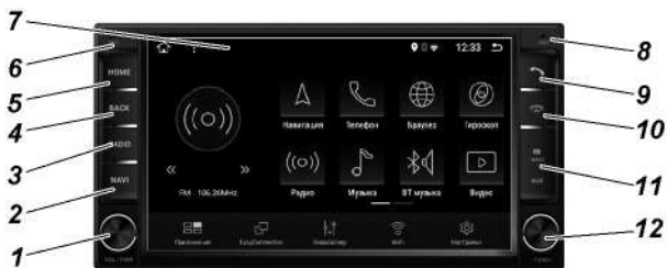
Рис. 3.24. Органы управления мультимедийным радиоаппаратом:
