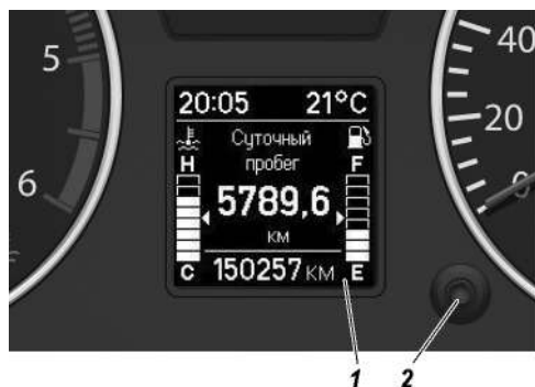
Рис. 3.7. Управление маршрутным компьютером на комбинации приборов 1 -жидкокристаллический дисплей; 2 -переключатель маршрутного компьютера
