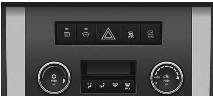
Рис. 3.5. Выключатели центральной консоли.
