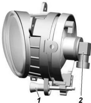
Рис. 9.40. Противотуманная фара: 1 -регулируочный винт; 2 -колодка жгута проводов
