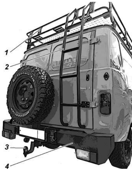
Рис.10.4. Багажник экспедиционный с лестницей 1 -багажник экспедиционный; 2 -лестница; 3 -тягово-сцепное устройство; 4 -задний силовой металлический бампер
