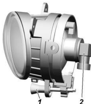
Рис. 9.32. Противотуманная фара: 1 -регулирующий винт; 2 -колодка жгута проводов
