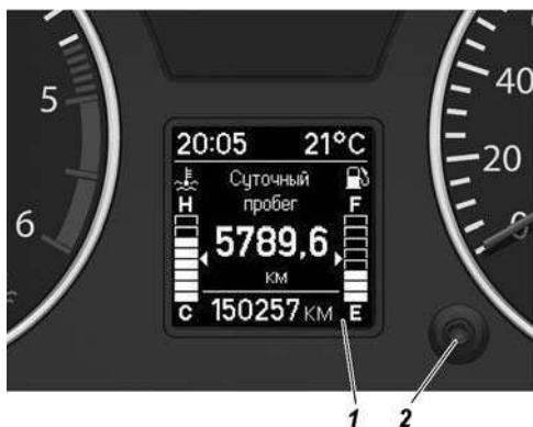
Рис. 3.5. Управление маршрутным компьютером на комбинации приборов: 1 -жидкокристаллический дисплей; 2 -переключатель маршрутного компьютера
