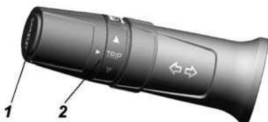
Рис. 3.5. Управление маршрутным компьютером на комбинации приборов: 1 -жидкокристаллический дисплей; 2 -переключатель маршрутного компьютера
