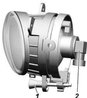
Рис. 9.33. Противотуманная фара: 1 -регулируемый винт; 2 -колодка жгута проводов
