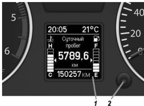
Рис. 3.4. Управление маршрутным компьютером на комбинации приборов: 1 -жидкокристаллический дисплей; 2 -переключатель маршрутного компьютера
