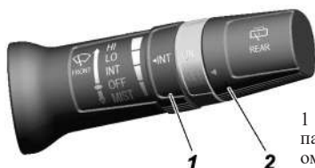
Рис. 3.10. Схема перемещения правого рычага подрулевого переключателя при управлении стеклоочистителем и омывателем (наименование позиций см. в тексте)
