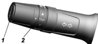
Рис. 3.6. Управление маршрутным компьютером на комбинации приборов: 1 - жидкокристаллический дисплей; 2 - переключатель маршрутного компьютера
