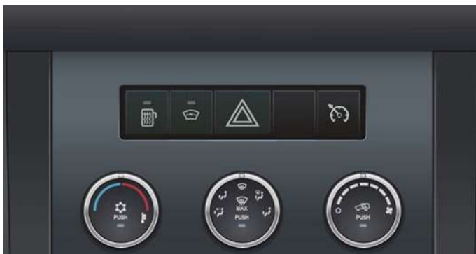
Рис. 3.4. Выключатели центральной консоли.
