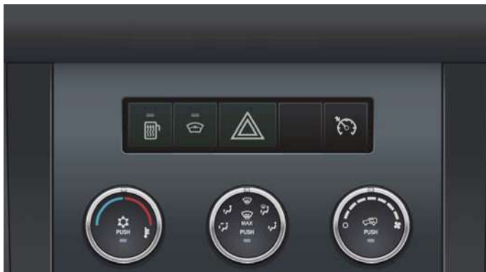
Рис. 3.3. Выключатели центральной консоли.
