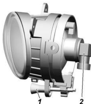
Рис. 9.32. Противотуманная фара: 1 -регулирующий винт; 2 -колодка жгута проводов
