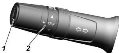
Рис. 3.8. Органы управления маршрутным компьютером на левом рычаге подрулевого переключателя: 1 -кнопка; 2 -кольцо переключателя «TRIP»
