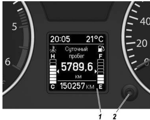
Рис. 3.7. Управление маршрутным компьютером на комбинации приборов 1 -жидкокристаллический дисплей; 2 -переключатель маршрутного компьютера
