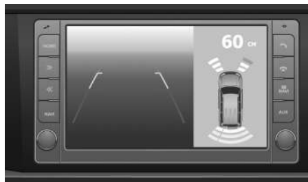
Рис. 3.20. Изображение с камеры заднего вида и информация системы помощи при парковке на экране мультимедийной системы
