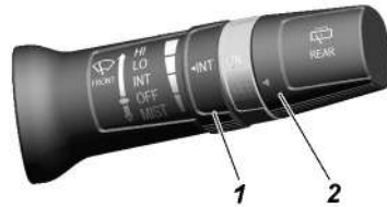
Рис. 3.12. Схема перемещения правого рычага подрулевого переключателя при управлении стеклоочистителем и омывателем (наименование позиций см. в тексте)
