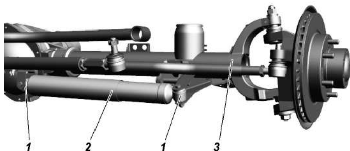
Рис. 9.22. Установка демфера (для УАЗ ПАТРИОТ):
