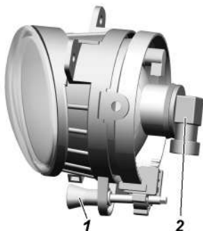
Рис. 9.40. Противотуманная фара: 1 -регулирующий винт; 2 -колодка жгута проводов
