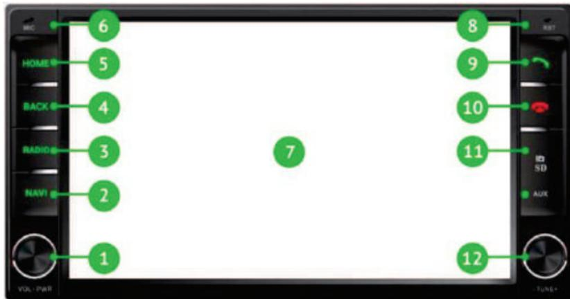
1. **(Vol/PWR)** Кнопка: включение/выключение проигрывателя, ручка регулировки громкости. Вращайте ручку плавно для регулировки громкости, при резком вращении возможна неравномерная регулировка громкости. Короткое нажатие на ручку включает устрой-
