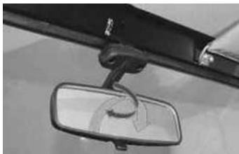
Рис. 3.8. Регулировка внутреннего зеркала
